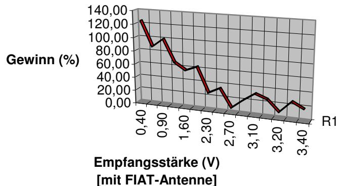
**Vergleich Opel-/Fiatantenne LW/MW**
